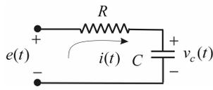
con  $v_c(0) = 0\text{v}$ ,  $e(t) = 10\text{v}$ ,  $R = 200 \cdot 10^3\Omega$  y  $C = 50 \cdot 10^{-6}\text{F}$ .
