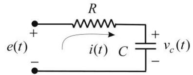
a) Encuentre el potencial en bornes del capacitor en función del tiempo  $v_c(t)$ , sabiendo que la tensión inicial del capacitor es:  $v_c(0) = 0$  volts y la excitación es:  $e(t) = 10$  volts.
