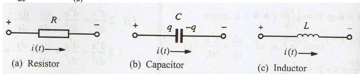
Figura 1.1: elementos pasivos de circuitos eléctricos.
