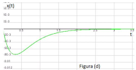
En la figura (d) se muestra un gráfico de la posición en función del tiempo.
