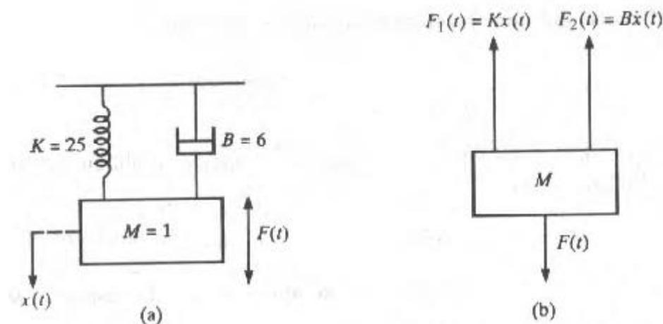
Utilizaremos la Figura (a) como referencia a este tipo de problemas, siendo la Figura (b) el diagrama de cuerpo libre. Las condiciones iniciales del sistema son  $x_0 = \dot{x}_0 = 0$  y la ecuación diferencial:
