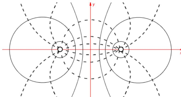
**Figura 2** – Líneas equipotenciales (trazo continuo) y líneas de fuerza (trazo discontinuo)
