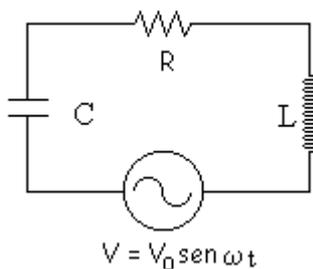
Figura 1: Representación de un circuito RLC con corriente variable
