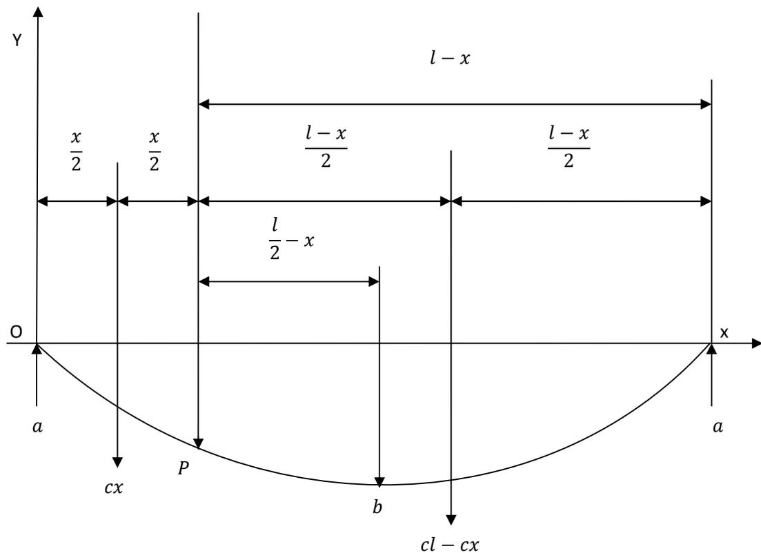
Figura 1: Viga apoyada sobre dos puntos
