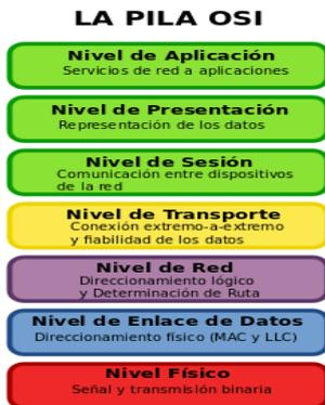
Figura 1: División en capas de las redes, modelo OSI.
