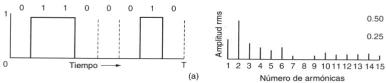
Figura 2: Una señal binaria y sus amplitudes de raíz cuadrada media de Fourier.
