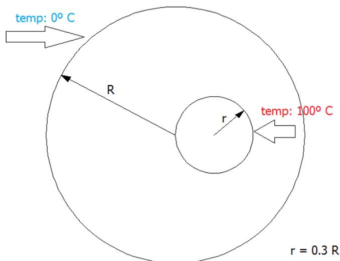
Figura 1 - Diagrama esquemático del problema de transferencia de calor.
