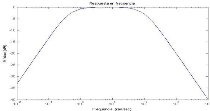
Figura 4 - Respuesta en frecuencia de un Filtro Pasa Banda
