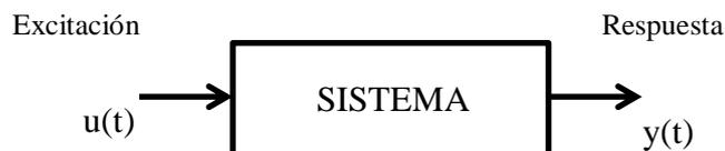
Figura 2 - Representación de un sistema con una entrada  $u(t)$  y una salida  $y(t)$
