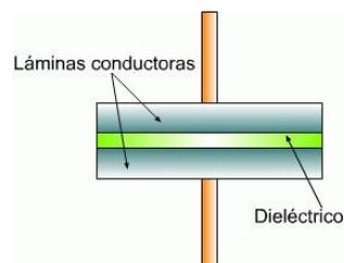
Figura 1: Representación esquemática de un capacitor
