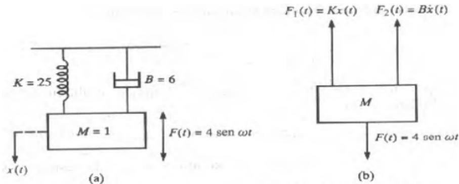
A partir del siguiente diagrama de cuerpo aislado se quiere determinar el desplazamiento resultante  $x(t)$  de la masa  $M$ , en el tiempo  $t$  sabiendo que  $w=2$ . Para ello se plantean las siguientes ecuaciones según la ley de Newton.
