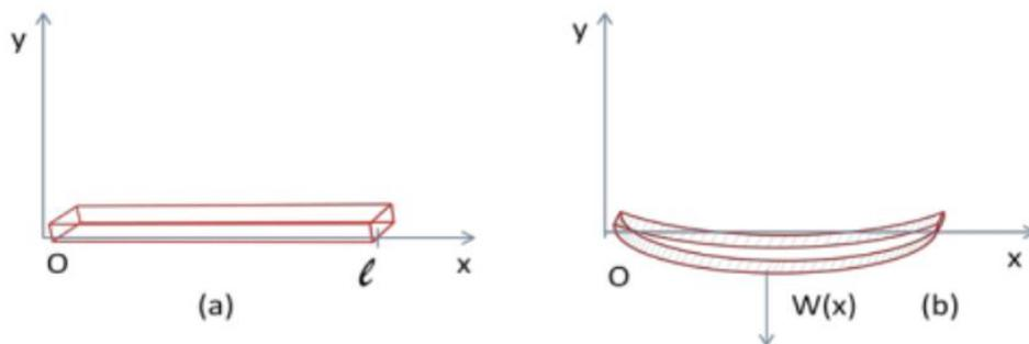
Figura 1 : Deflexión transversal de una viga : (a) posición inicial ; (b) posición desplazada
