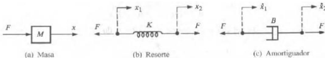
Figura 1: Elementos componentes de un sistema mecánico de traslación.
