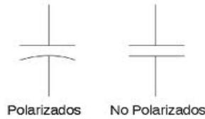
Figura 2: Representación esquemática de un capacitor
