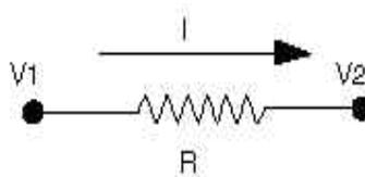
Figura 1: Representación simbólica de un resistor
