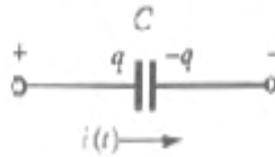
Figura 2: Representación simbólica de un capacitor
