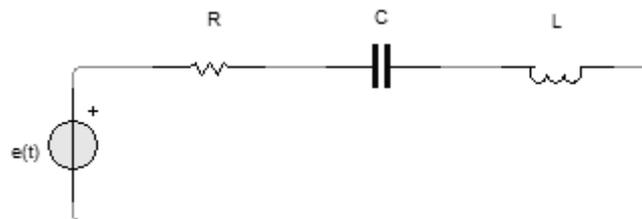
**Figura 1 - Esquema del circuito**
