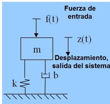
Figura 1: Sistema básico de un amortiguador
