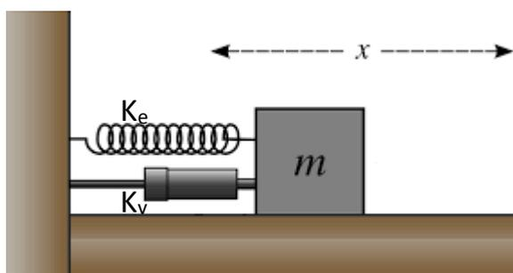
Figura 1: Masa unida a un resorte de constante elástica  $k_e$  y a un amortiguador de constante viscosa  $k_v$
