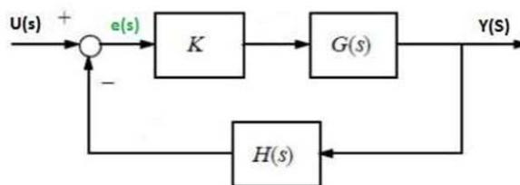
Figura 3- Esquema de realimentación
