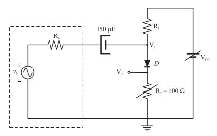
El punro de polarización se determinará midiendo con multímetro para varios valores de  $R_1$ , las tensiones  $V_{cc}$ ,  $V_1$  y  $V_2$ . La resistencia que presenta el diodo a la señal puede determinarse midiendo la atenuación que ofrece el divisor resistivo formado por la resistencia dinámica del diodo y la resistencia  $R_2$  cuando se aplica una señal al mismo.
